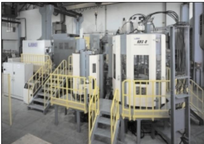
Abb. 2: New Rheocasting Anlage, bestehend aus einer Ube HVSC 800 NRC Squeeze Casting Maschine mit Kühlstation und Becherreinigungsanlage für Abgussmengen bis 7,5 kg Aluminium
