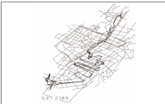
Abb. 6: Ortungssprünge mit GPS-Satellitenortung in der südlichen Innenstadt von Stuttgart (Martin Stark, Uni Stuttgart, 1999)
